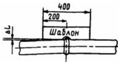
Рис. 12. Схема определения отклонения от прямолинейности оси трубы
