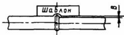
Рис. 11. Схема определения смещения кромок стыкуемых труб
